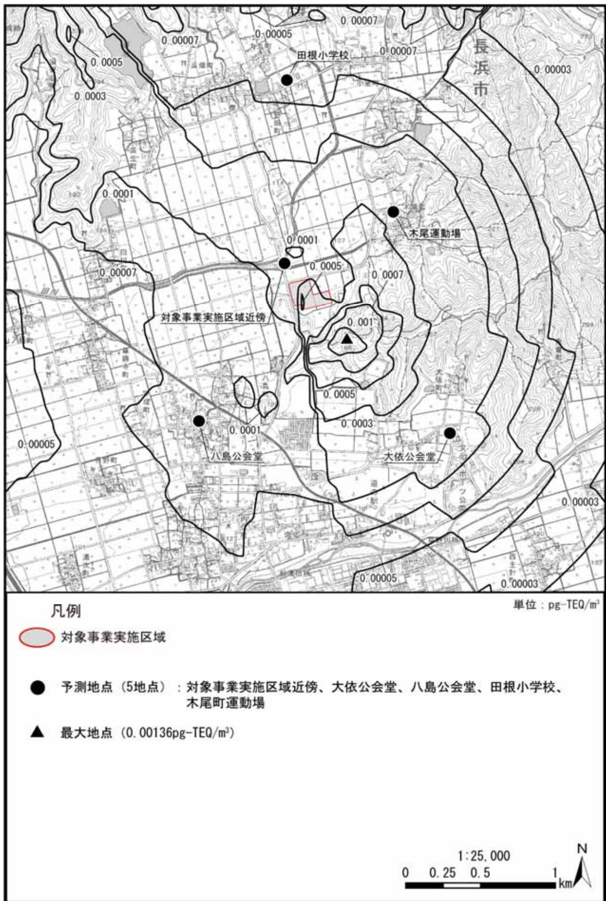
図 3.1-14(5) 長期平均濃度予測結果[ダイオキシン類（年平均値寄与分）] （焼却施設＋バイオガス化施設＋新斎場）（拡散幅補正あり）
