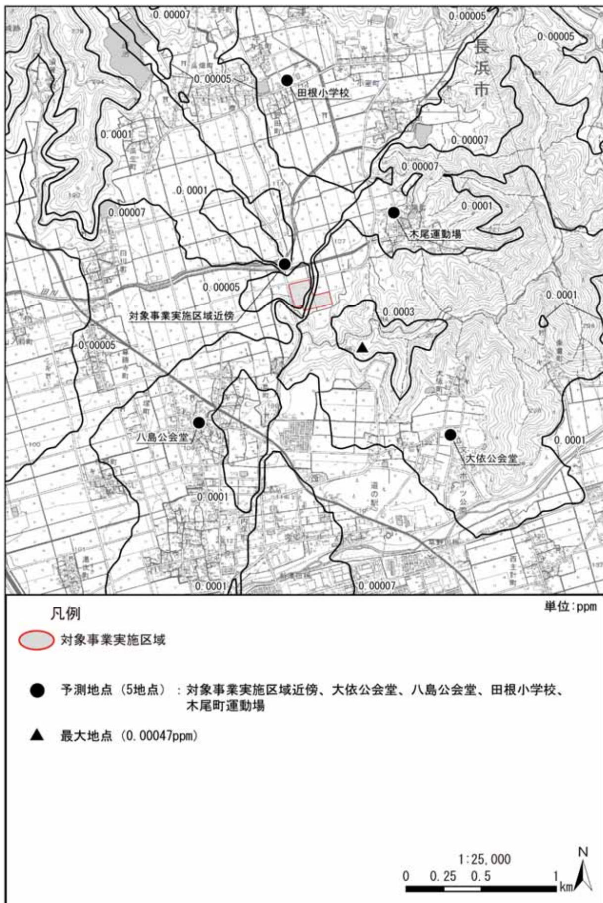
図 3.1-5(2) 長期平均濃度予測結果[二酸化窒素 (年平均値寄与分)] (焼却施設+バイオガス化施設) (拡散幅補正なし)
