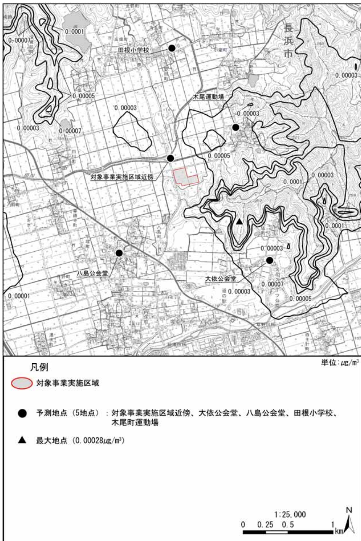
図 3.1-8(6) 長期平均濃度予測結果[水銀 (年平均値寄与分)] (焼却施設) (拡散幅補正なし)
