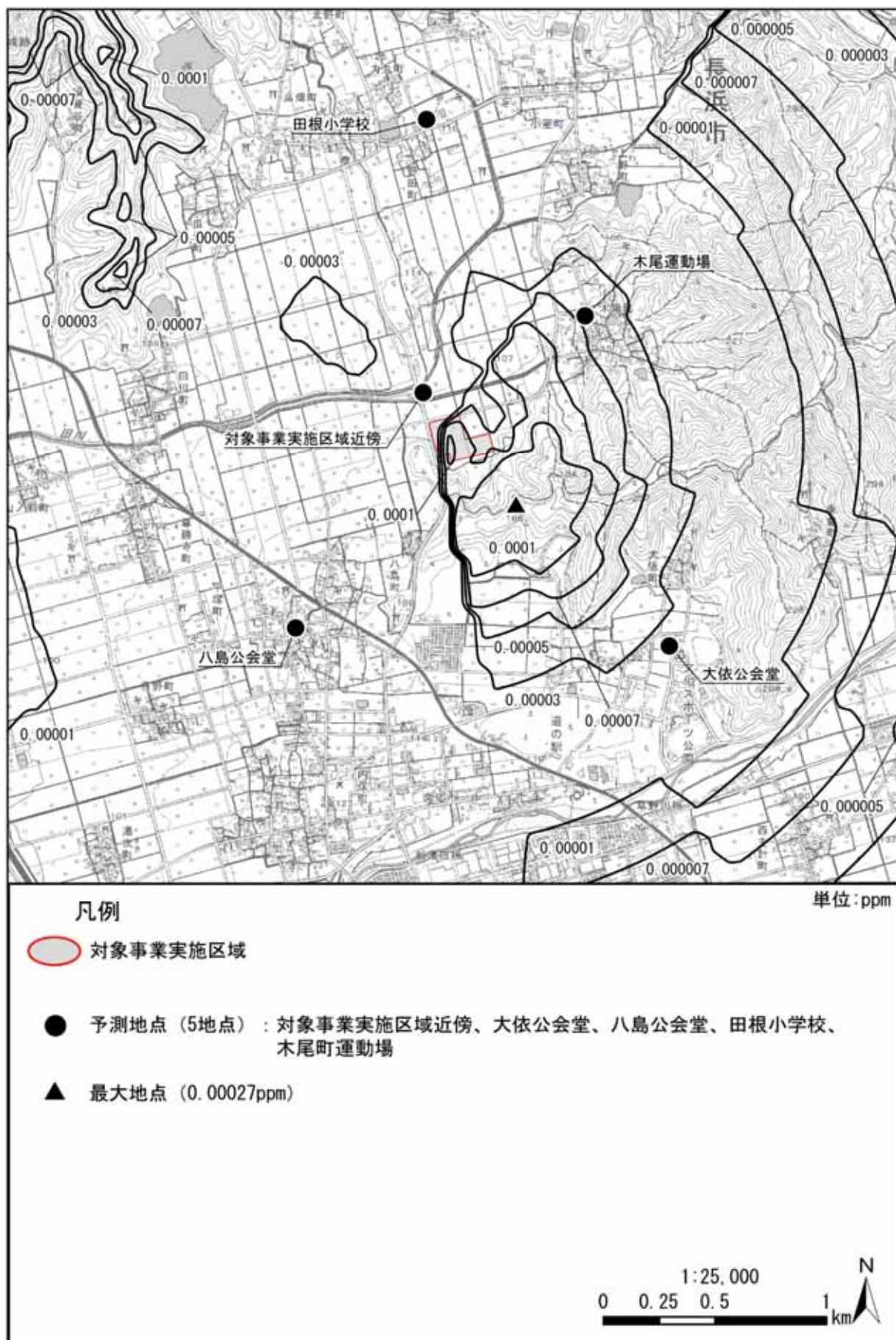
図 3.1-6(1) 長期平均濃度予測結果[二酸化硫黄 (年平均値寄与分)] (焼却施設) (拡散幅補正あり)
