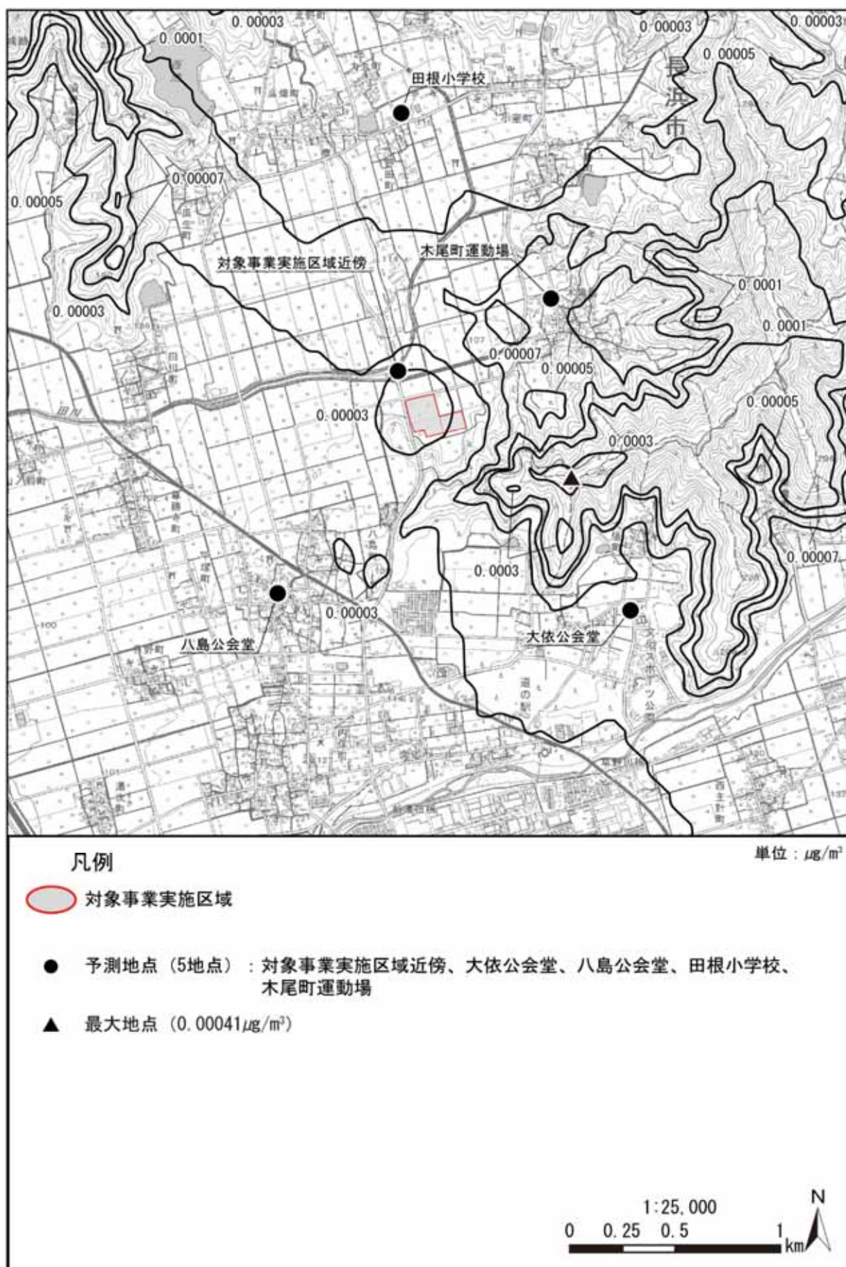
図 3.1-4(6) 長期平均濃度予測結果[水銀 (年平均値寄与分)] (焼却施設) (拡散幅補正なし)
