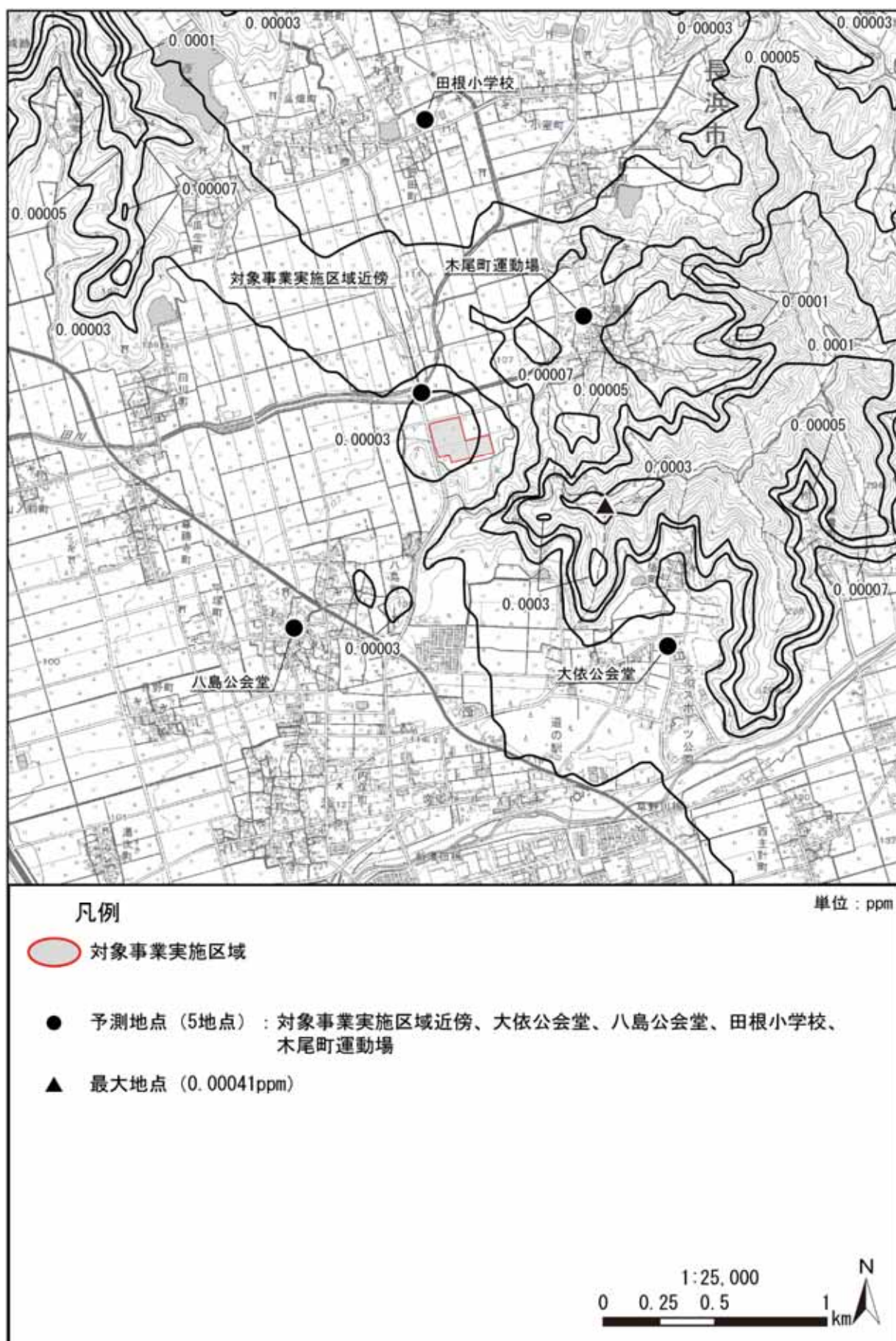
図 3.1-4(4) 長期平均濃度予測結果[塩化水素 (年平均値寄与分)] (焼却施設) (拡散幅補正なし)
