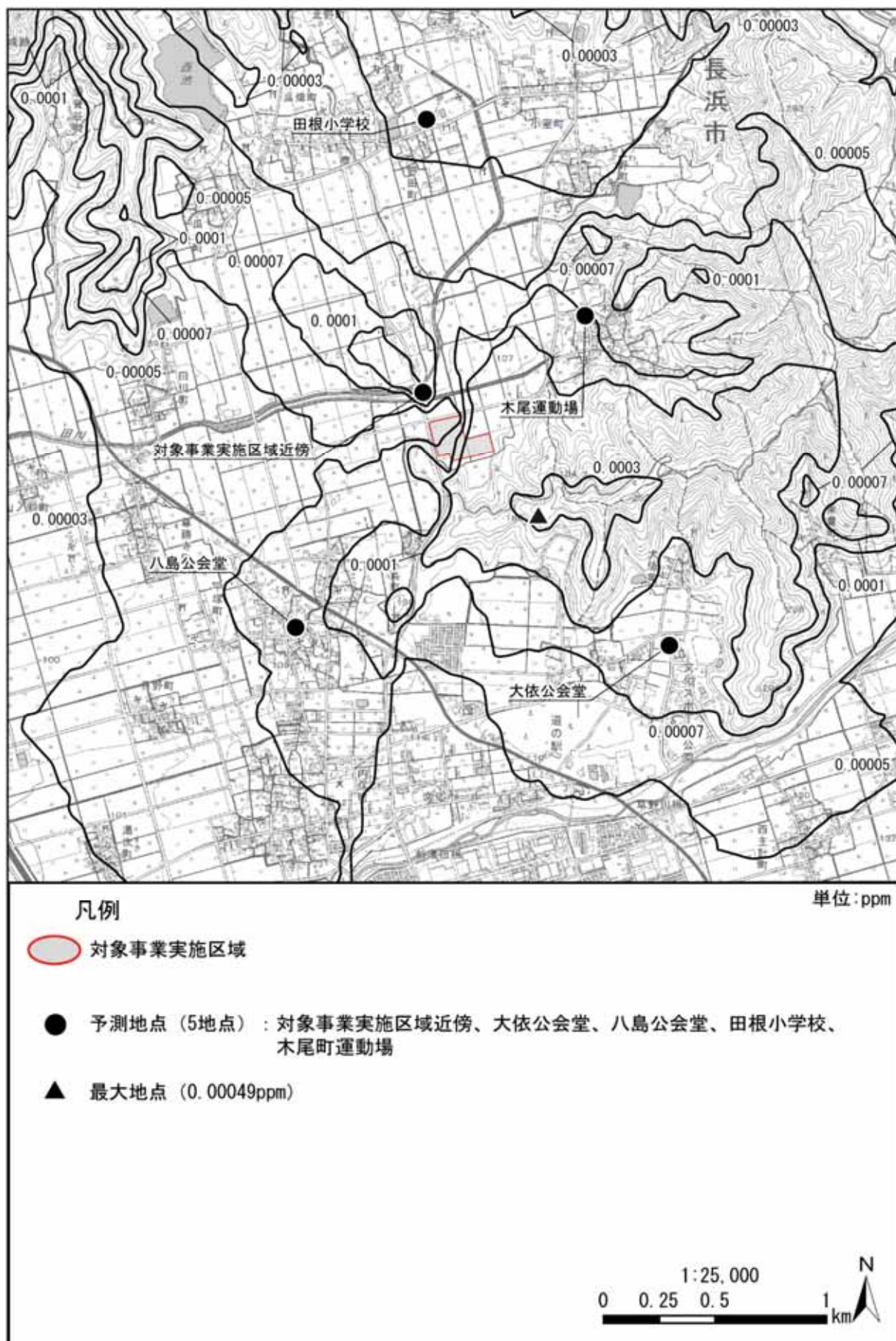
図 3.1-9(1) 長期平均濃度予測結果[二酸化硫黄（年平均値寄与分）] （焼却施設+バイオガス化施設）（拡散幅補正なし）
