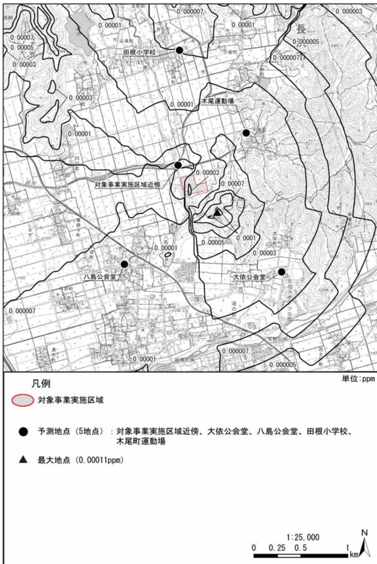
図 3.1-6(2) 長期平均濃度予測結果[二酸化窒素 (年平均値寄与分)] (焼却施設) (拡散幅補正あり)
