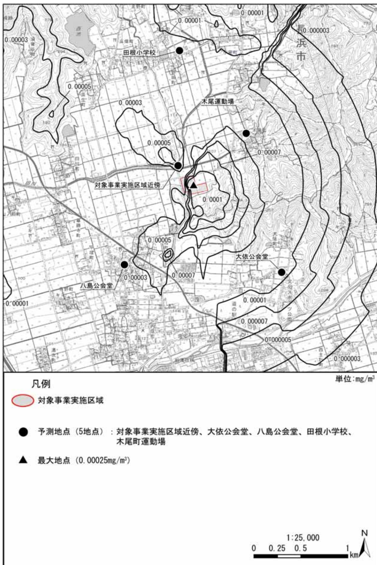
図 3.1-7(3) 長期平均濃度予測結果[浮遊粒子状物質 (年平均値寄与分)] (焼却施設+バイオガス化施設) (拡散幅補正あり)
