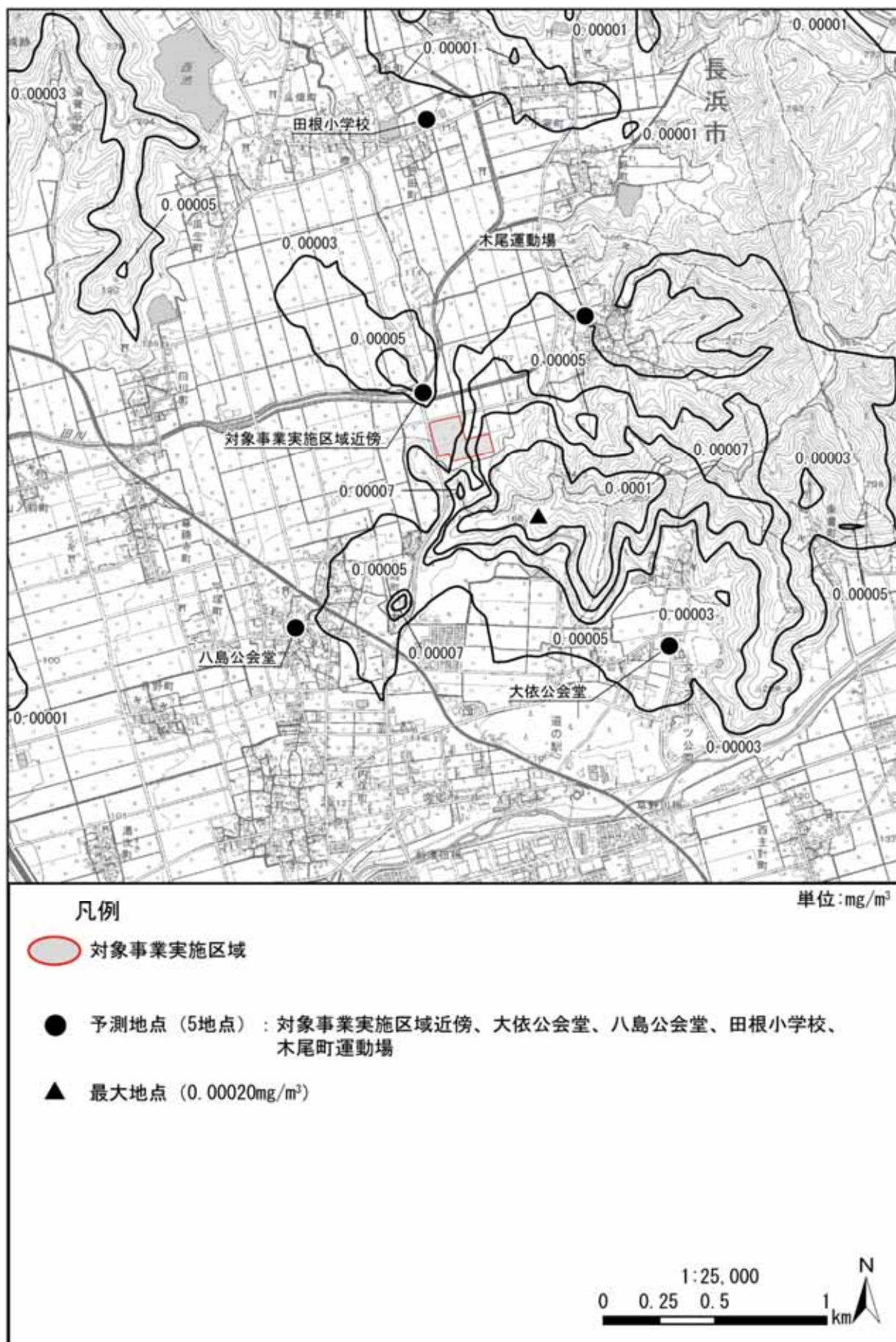
図 3.1-9(3) 長期平均濃度予測結果[浮遊粒子状物質 (年平均値寄与分)] (焼却施設+バイオガス化施設) (拡散幅補正なし)
