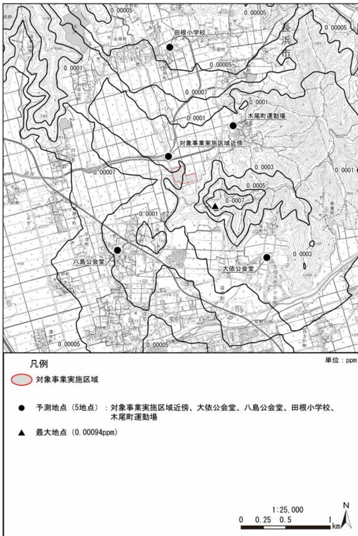
図 3.1-15(1) 長期平均濃度予測結果[二酸化硫黄（年平均値寄与分）] （焼却施設＋バイオガス化施設＋新斎場）（拡散幅補正なし）
