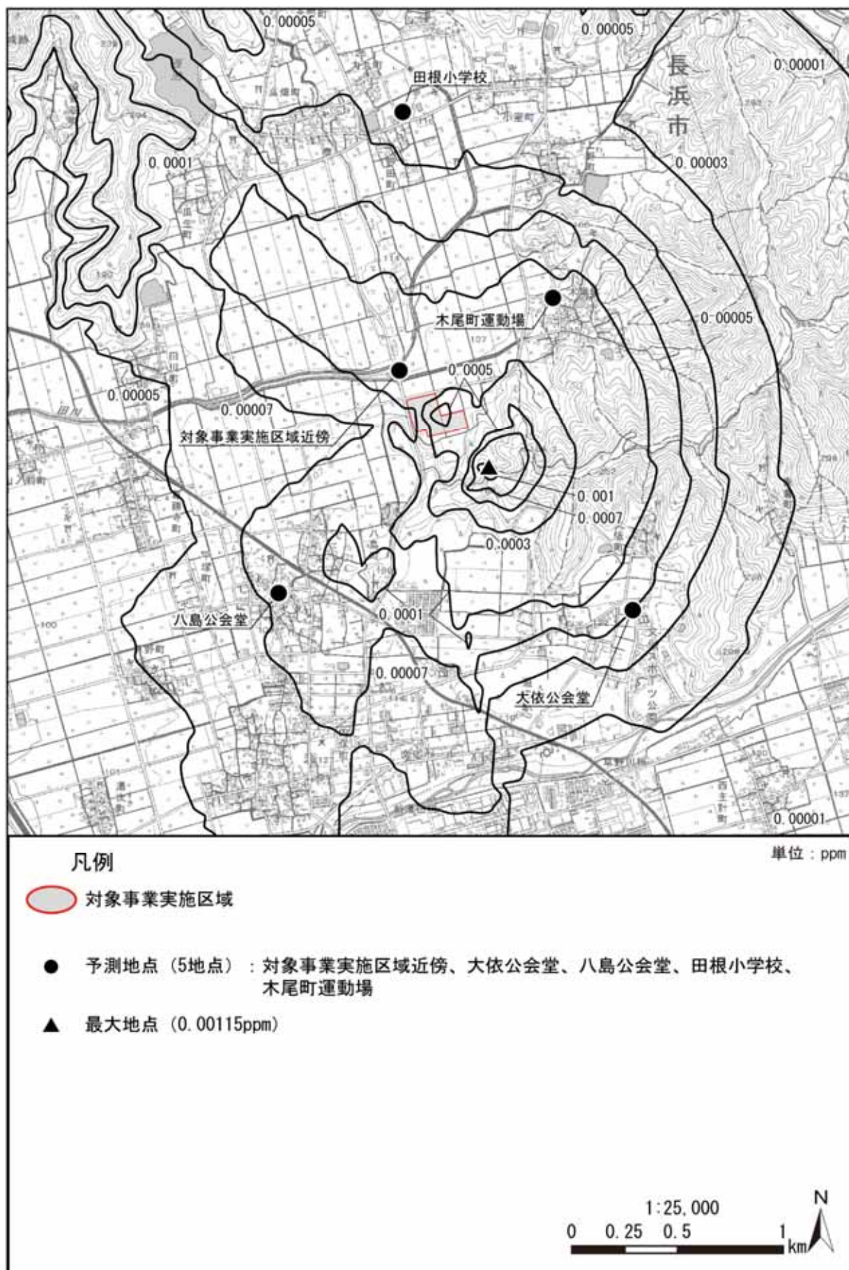
図 3.1-14(1) 長期平均濃度予測結果[二酸化硫黄（年平均値寄与分）] （焼却施設＋バイオガス化施設＋新斎場）（拡散幅補正あり）
