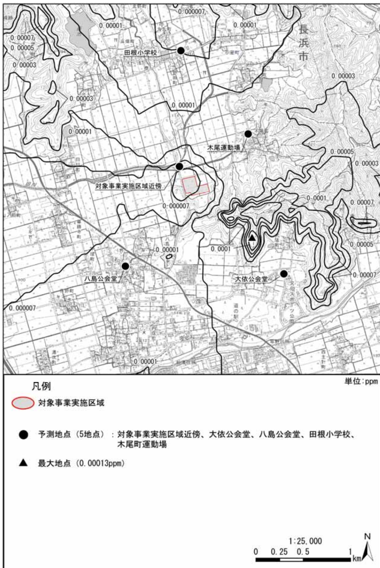
図 3.1-8(2) 長期平均濃度予測結果[二酸化窒素 (年平均値寄与分)] (焼却施設) (拡散幅補正なし)
