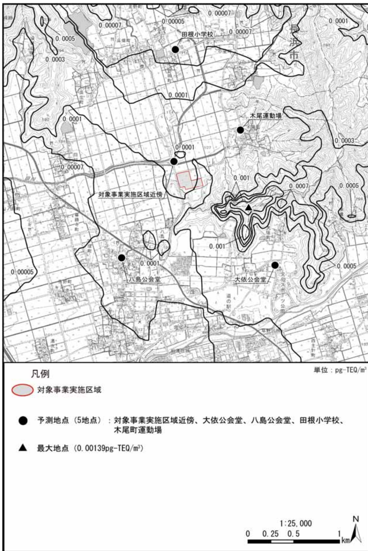
図 3.1-15(5) 長期平均濃度予測結果[ダイオキシン類（年平均値寄与分）] （焼却施設＋バイオガス化施設＋新斎場）（拡散幅補正なし）
