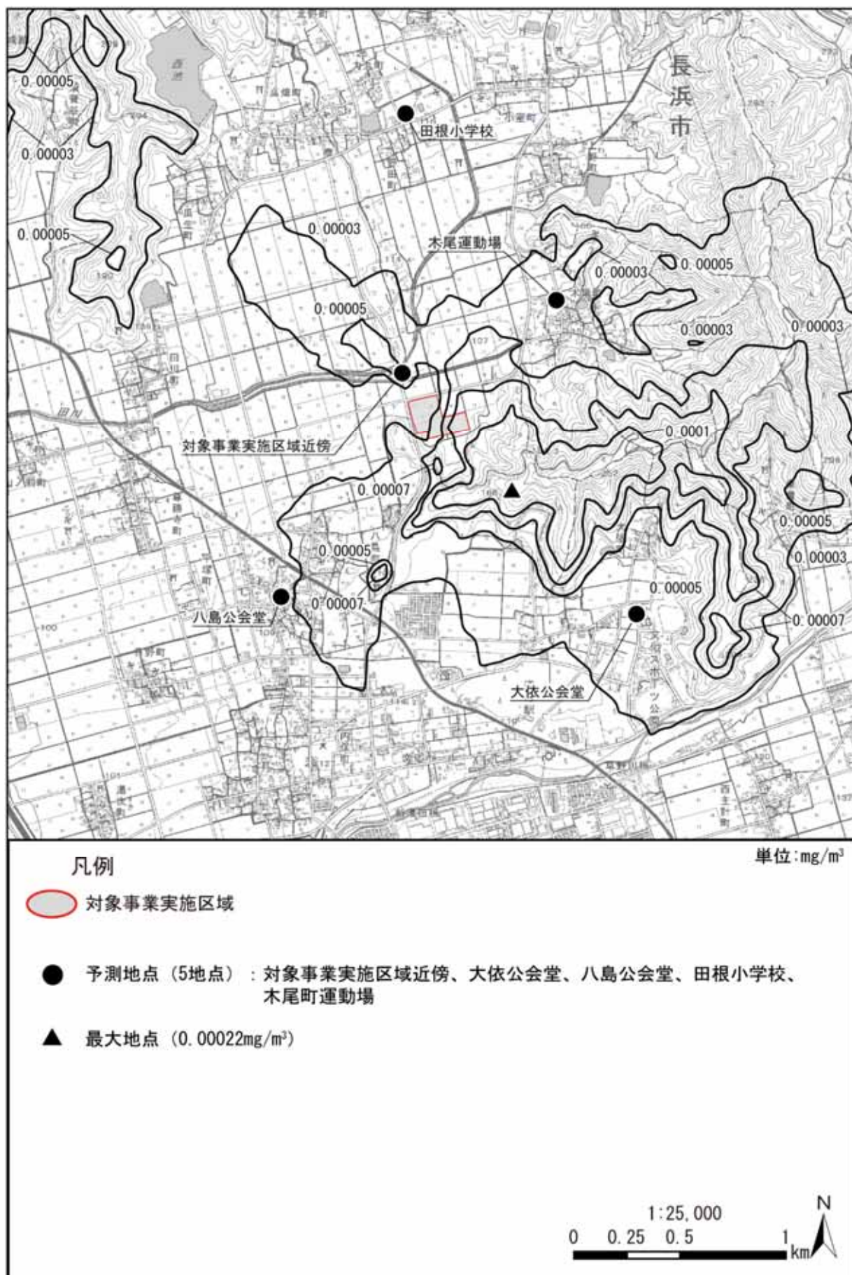
図 3.1-5(3) 長期平均濃度予測結果[浮遊粒子状物質 (年平均値寄与分)] (焼却施設+バイオガス化施設)(拡散幅補正なし)
