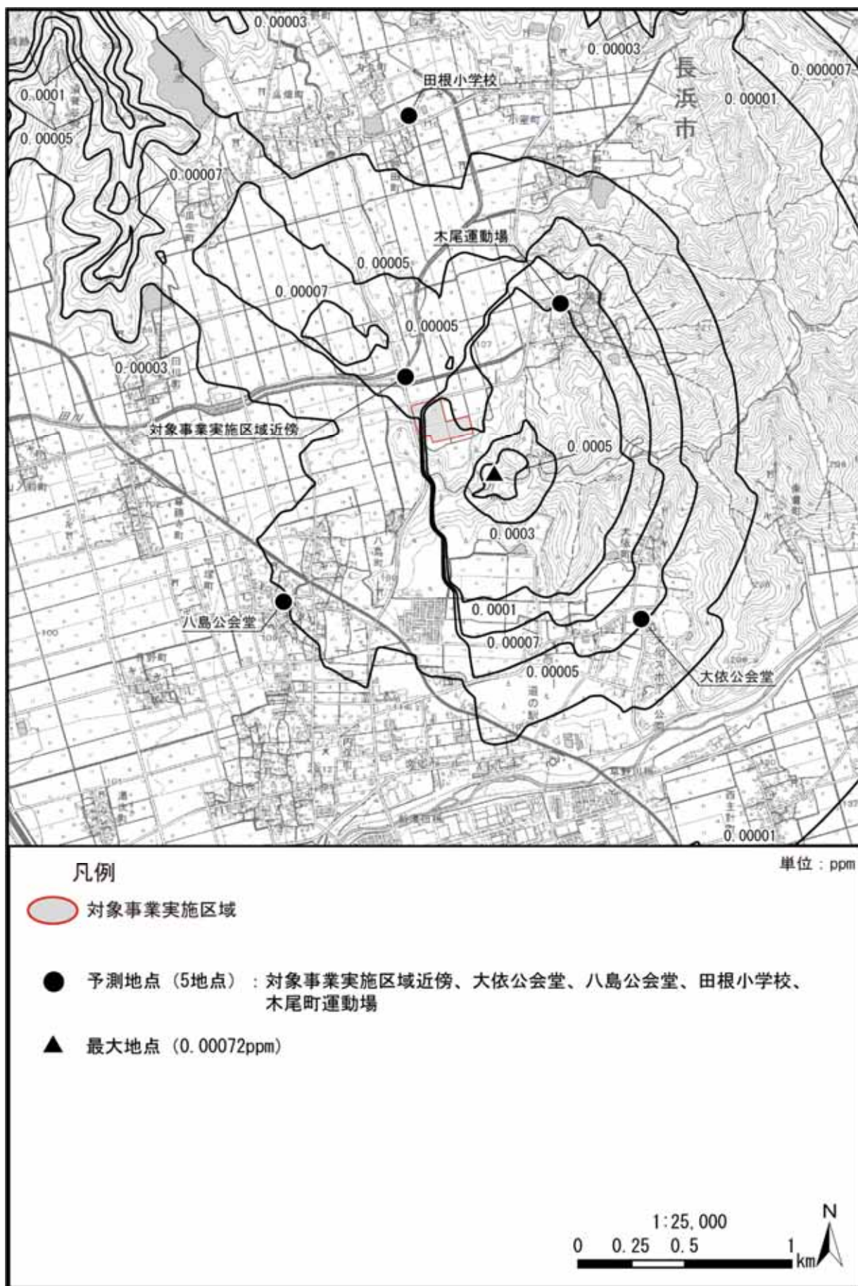
図 3.1-14(4) 長期平均濃度予測結果[塩化水素（年平均値寄与分）] （焼却施設＋バイオガス化施設＋新斎場）（拡散幅補正あり）
