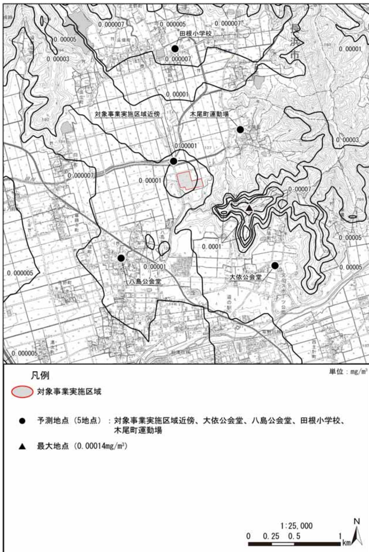
図 3.1-4(3) 長期平均濃度予測結果[浮遊粒子状物質 (年平均値寄与分)] (焼却施設) (拡散幅補正なし)
