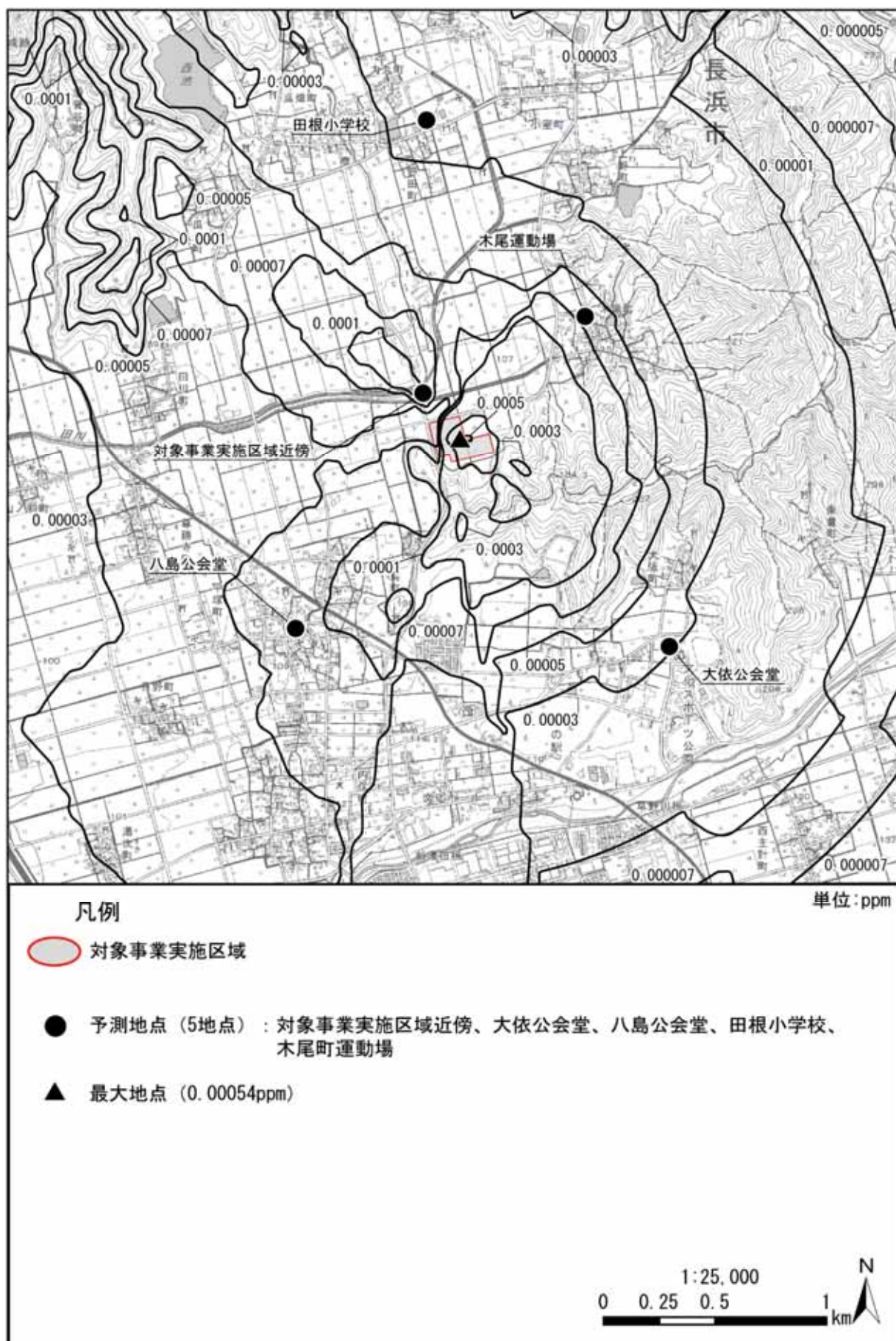
図 3.1-7(1) 長期平均濃度予測結果[二酸化硫黄(年平均値寄与分)] (焼却施設+バイオガス化施設)(拡散幅補正あり)
