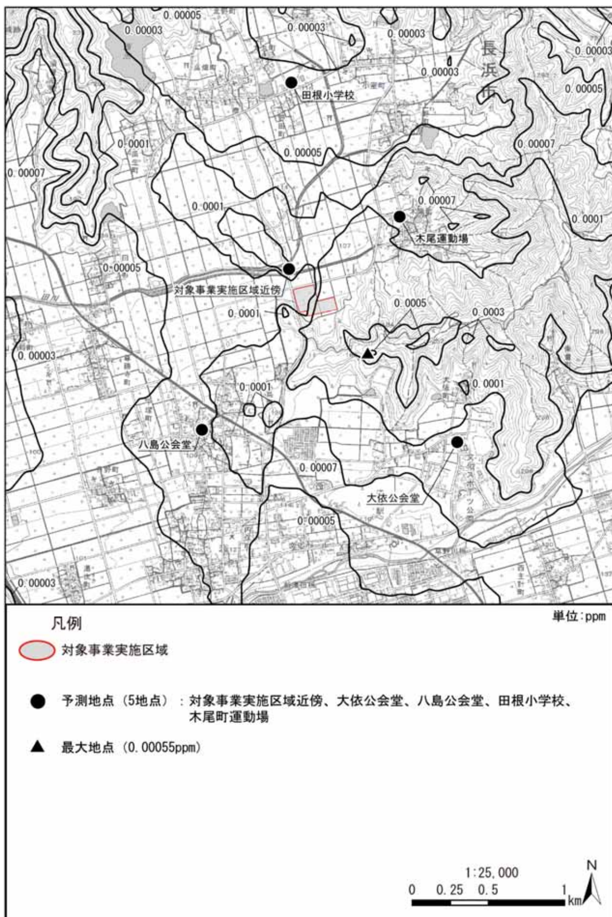
図 3.1-5(1) 長期平均濃度予測結果[二酸化硫黄 (年平均値寄与分)] (焼却施設+バイオガス化施設) (拡散幅補正なし)
