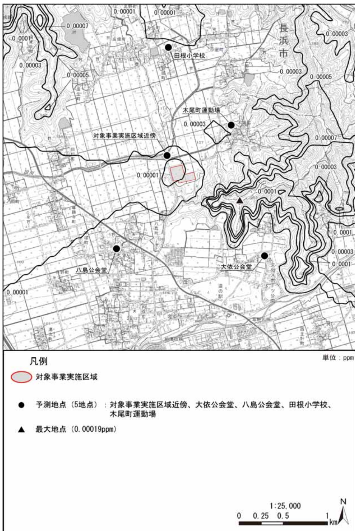
図 3.1-4(2) 長期平均濃度予測結果[二酸化窒素（年平均値寄与分）]（焼却施設）（拡散幅補正なし）
