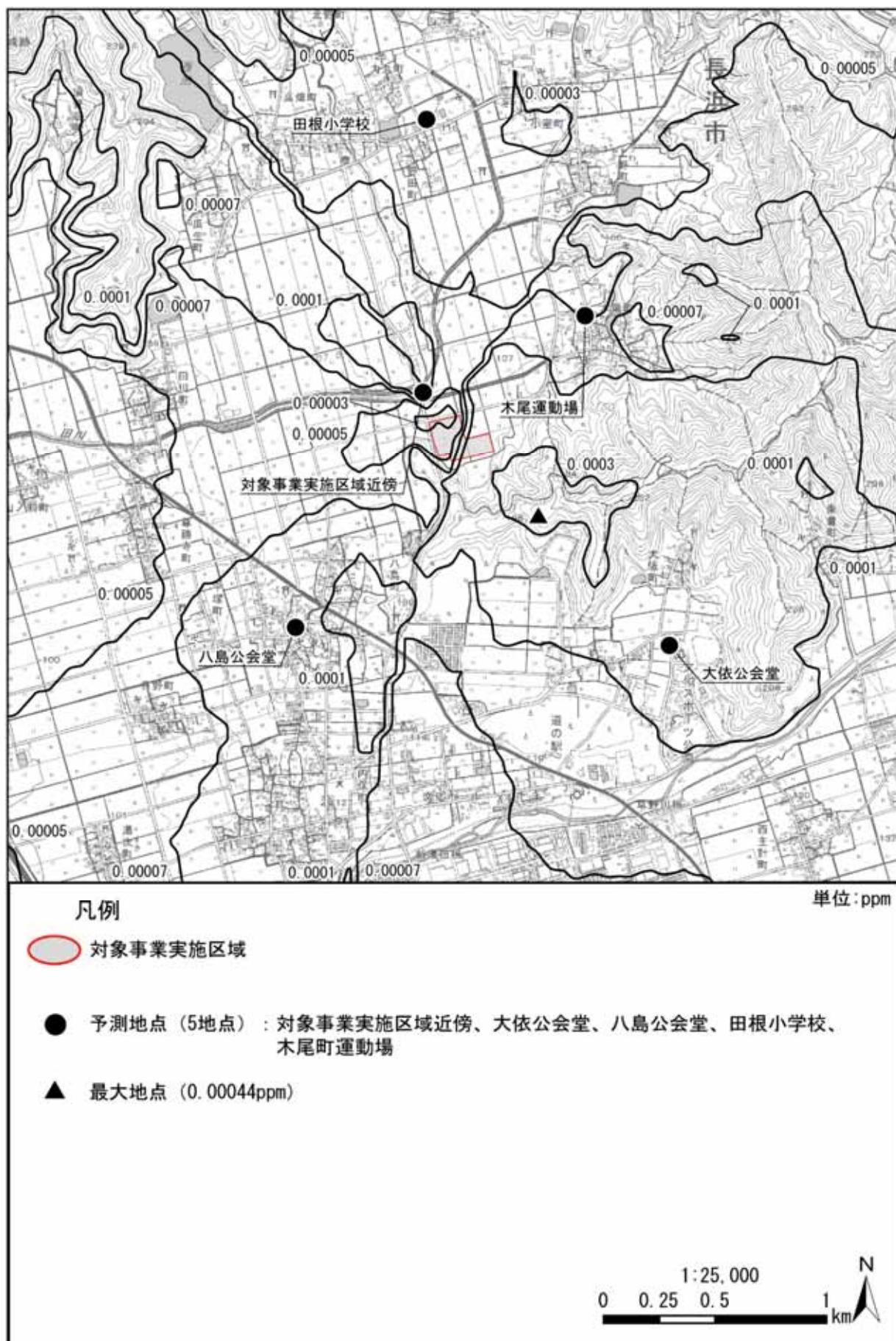
図 3.1-9(2) 長期平均濃度予測結果[二酸化窒素 (年平均値寄与分)] (焼却施設+バイオガス化施設) (拡散幅補正なし)
