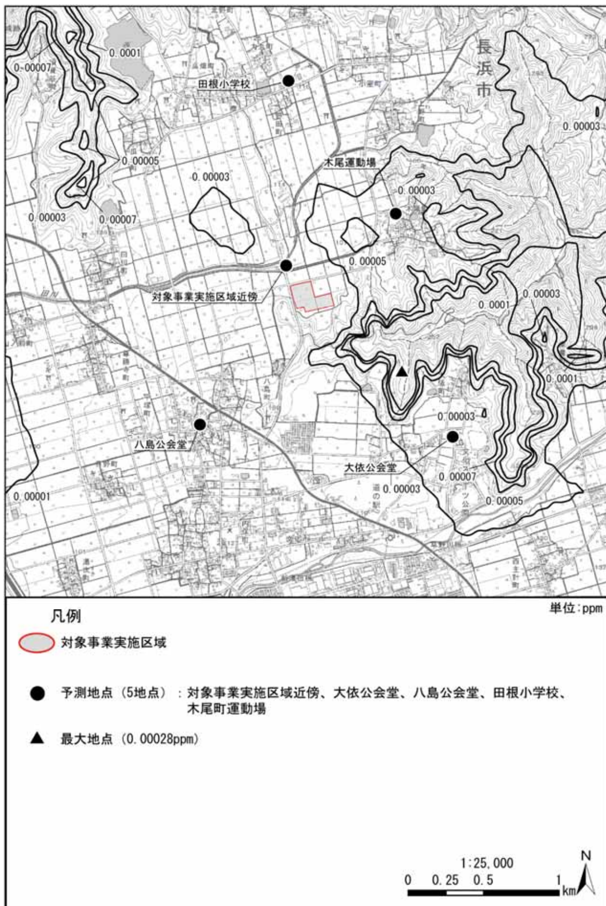
図 3.1-8(1) 長期平均濃度予測結果[二酸化硫黄 (年平均値寄与分)] (焼却施設) (拡散幅補正なし)
