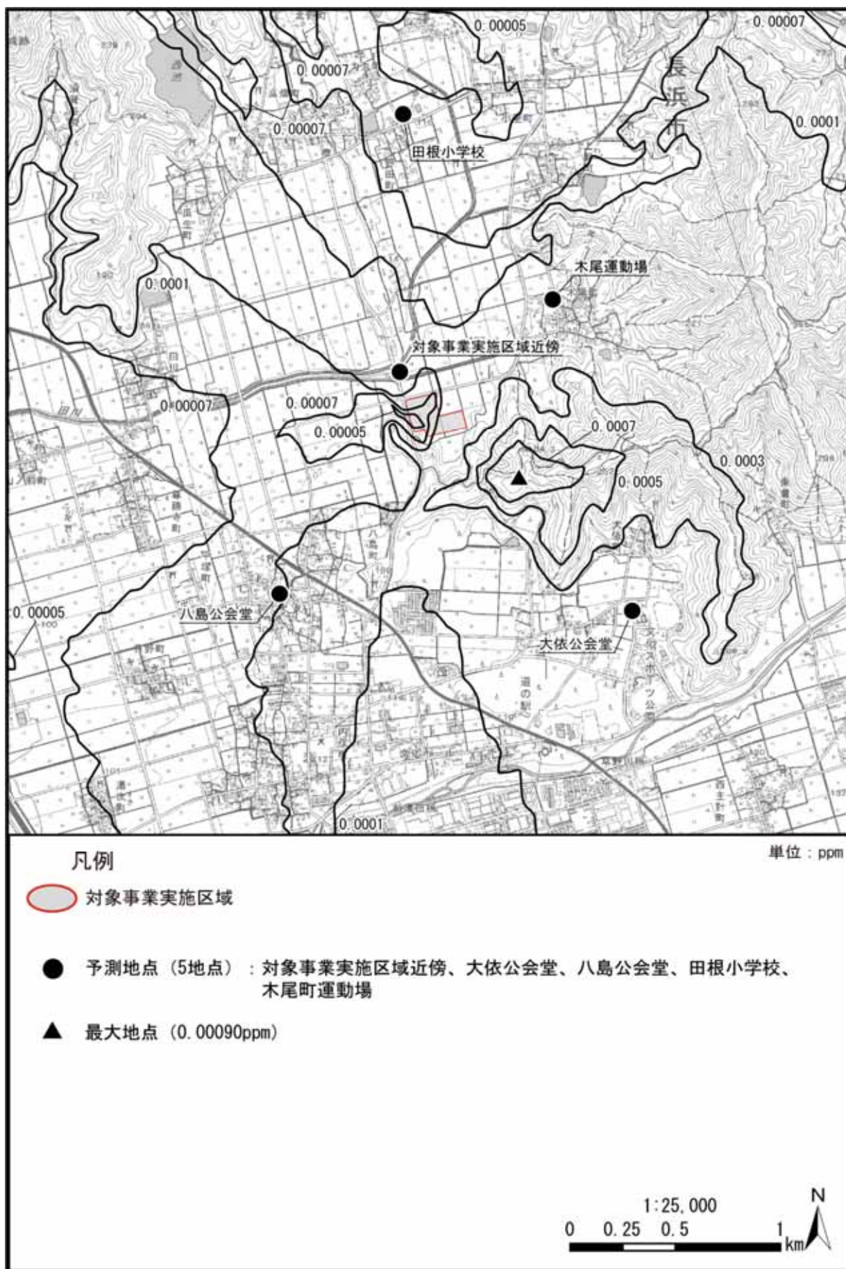
図 3.1-15(2) 長期平均濃度予測結果[二酸化窒素（年平均値寄与分）] （焼却施設＋バイオガス化施設＋新斎場）（拡散幅補正なし）
