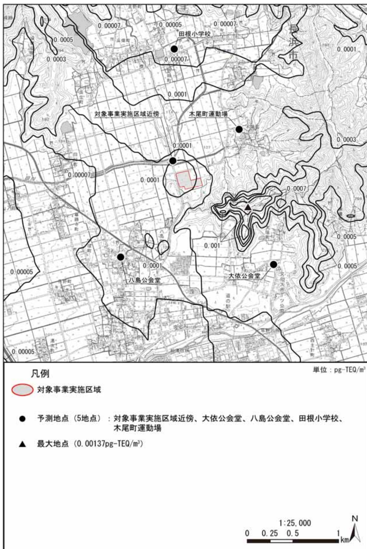
図 3.1-4(5) 長期平均濃度予測結果[ダイオキシン類（年平均値寄与分）]（焼却施設）（拡散幅補正なし）
