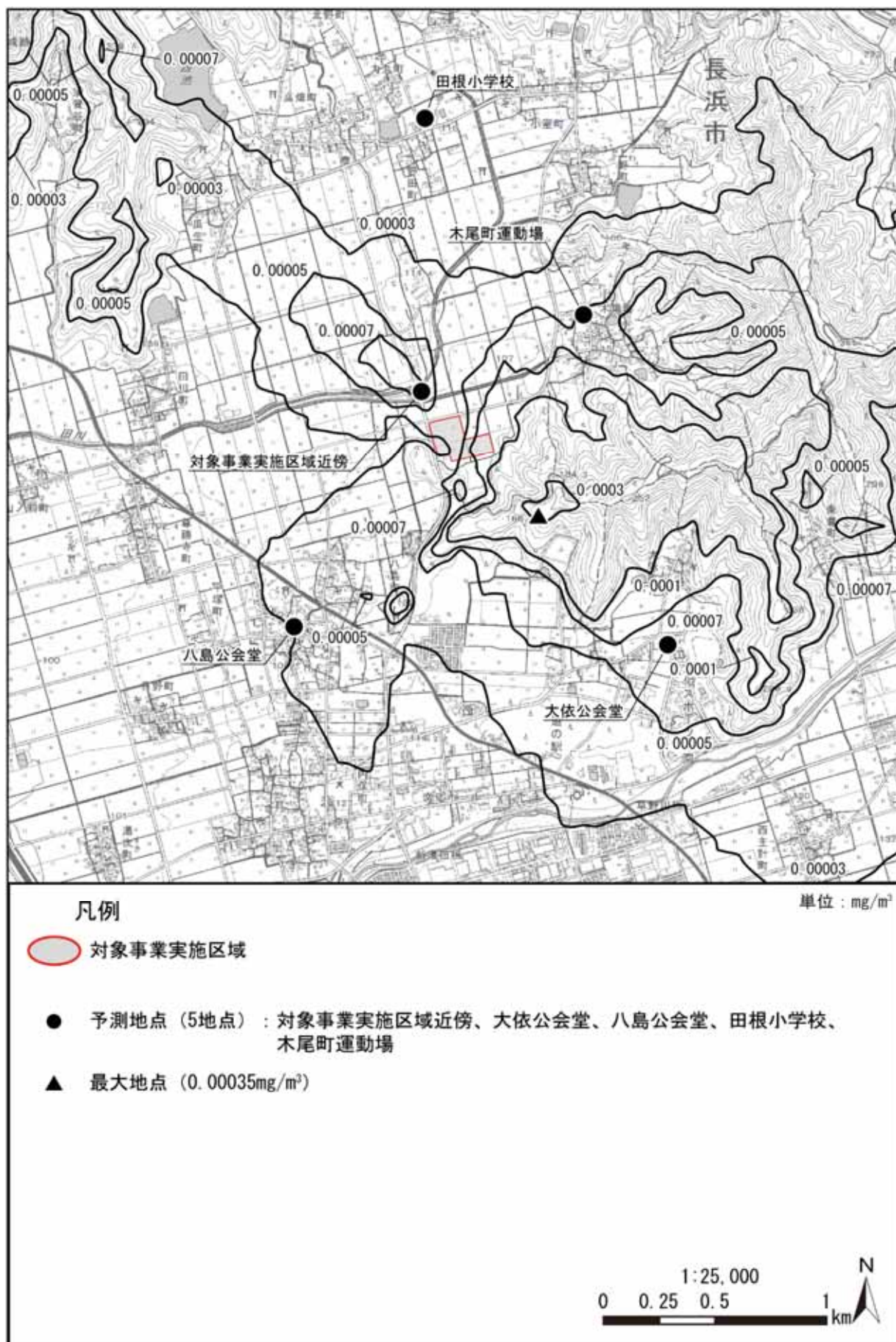
図 3.1-15(3) 長期平均濃度予測結果[浮遊粒子状物質 (年平均値寄与分)] (焼却施設+バイオガス化施設+新斎場) (拡散幅補正なし)
