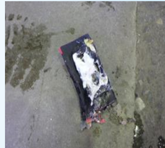
破裂したと思われるモバイルバッテリー (2件目)
