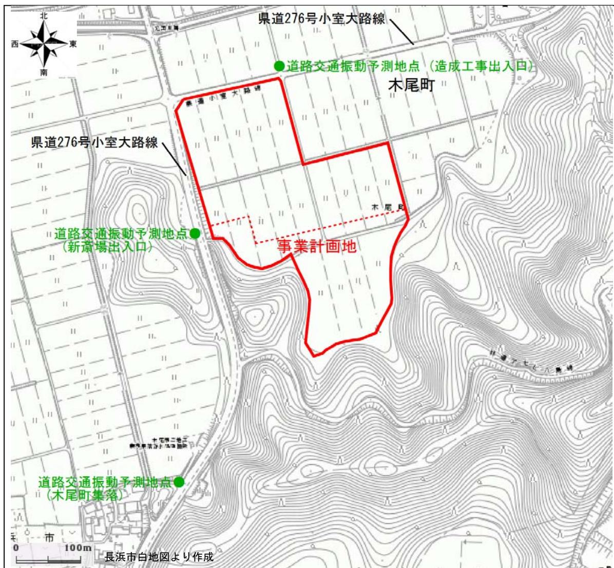
図 6-3-4 造成盛土運搬車両の走行に伴う道路交通振動予測地点
