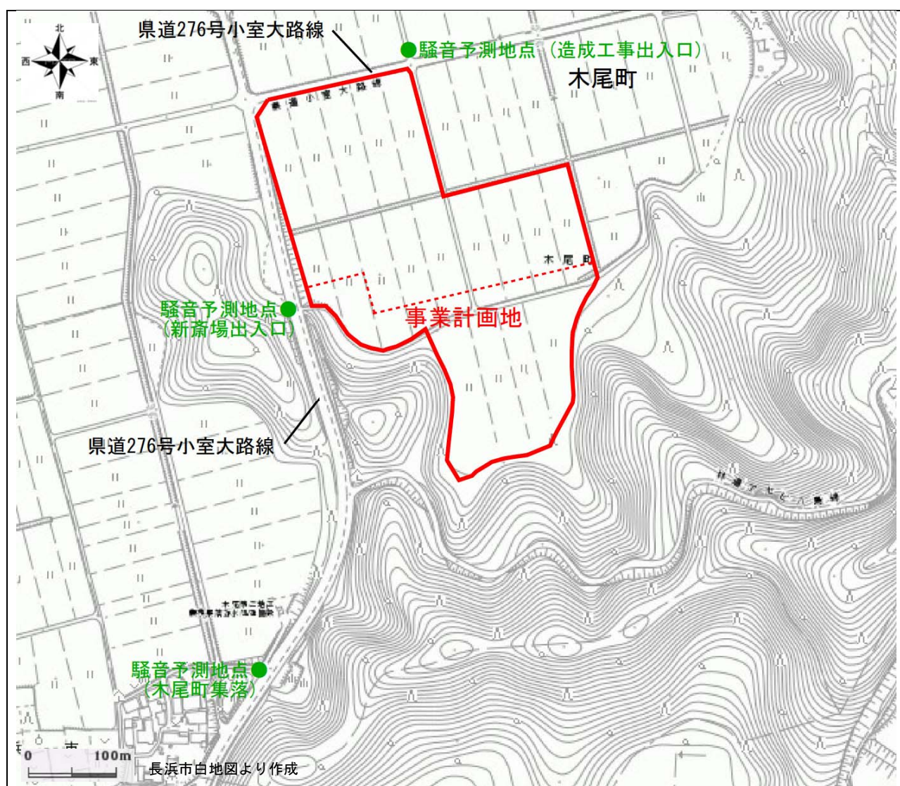
図 6-2-6 造成の施工に伴う騒音予測地点
