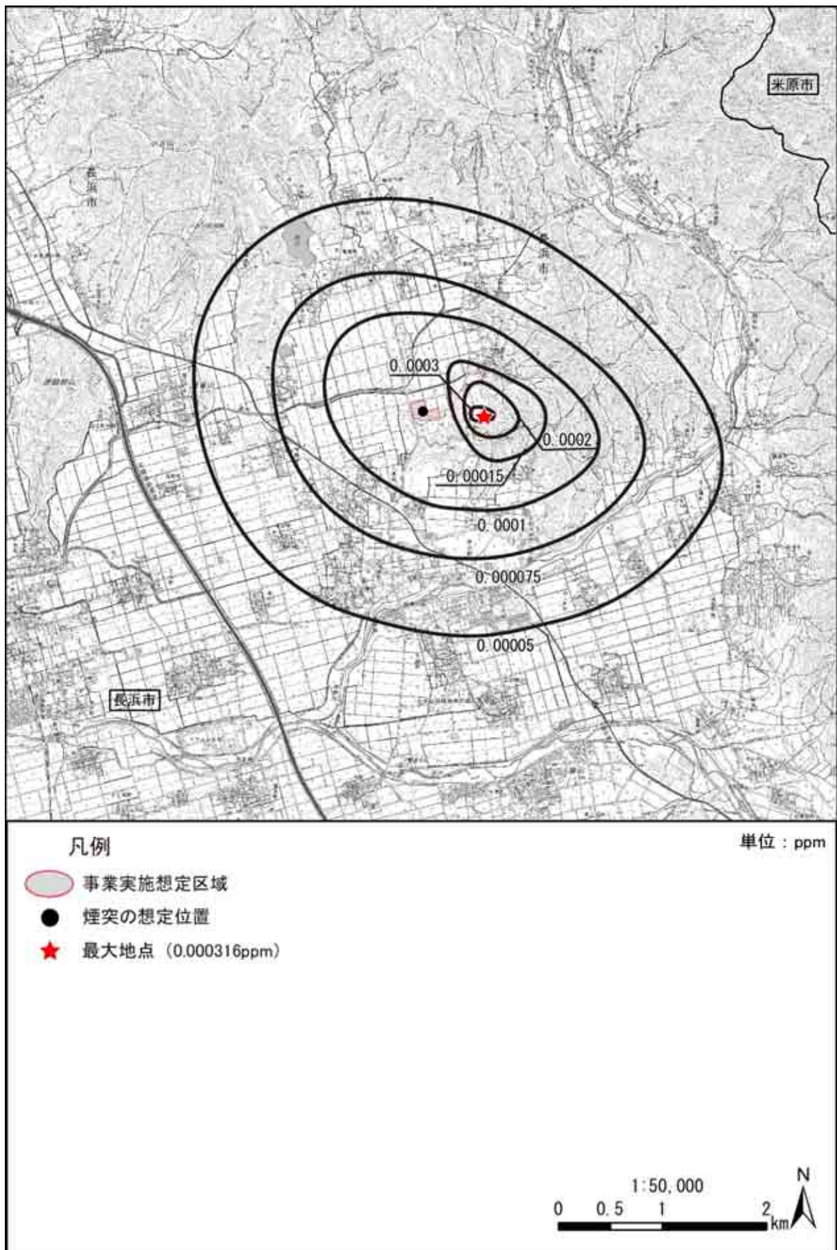
図 5.1-10(2) 二酸化硫黄の寄与濃度予測結果図 (B案 (煙突高さ 80m))
