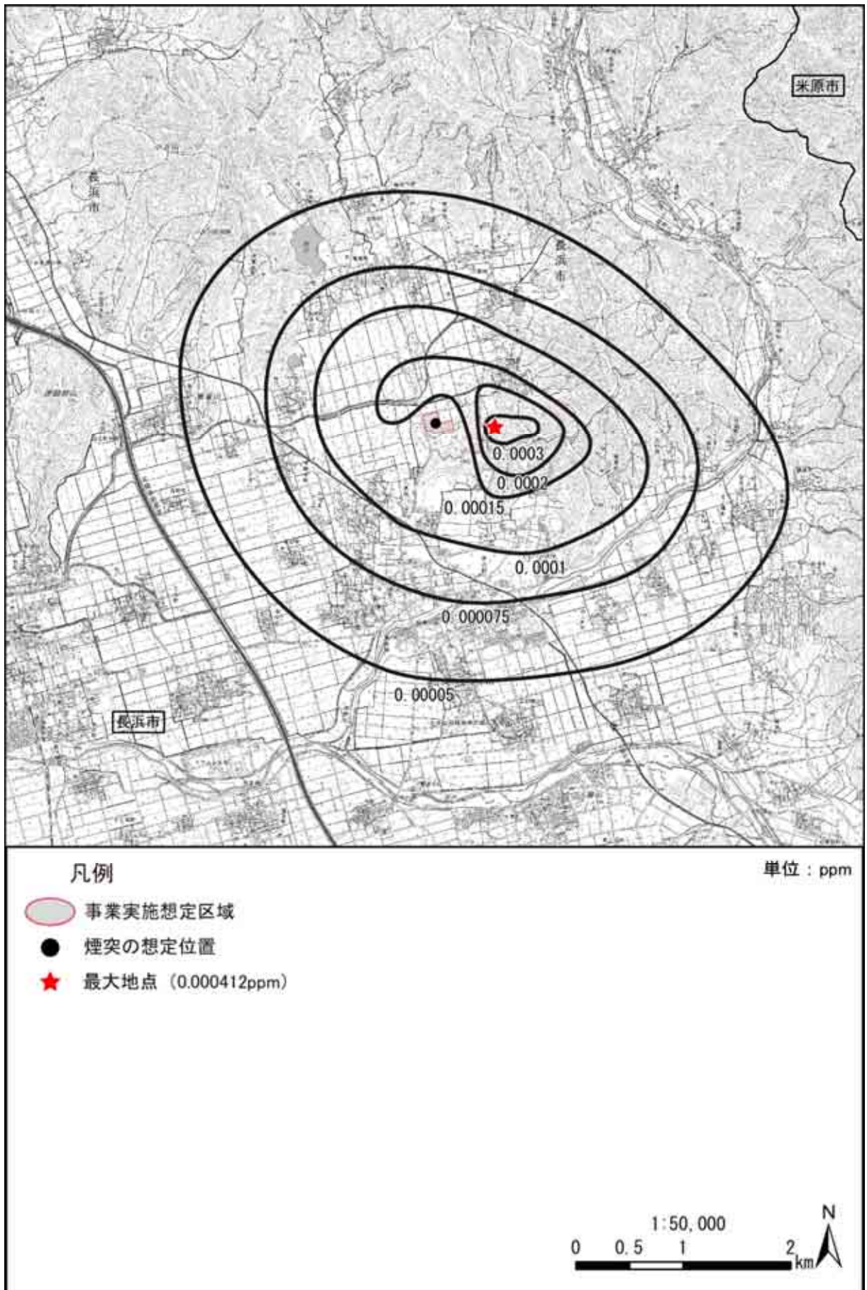
図 5.1-10(1) 二酸化硫黄の寄与濃度予測結果図 (A案 (煙突高さ 59m))
