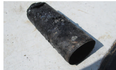
▲不燃ごみの中から発見されたスプレー缶(令和4年10月)
