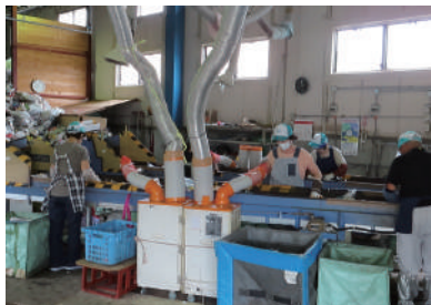
▲収集されたプラスチック製容器包装はクリスタルプラザで手作業で選別し、不適物を取り除いています。
